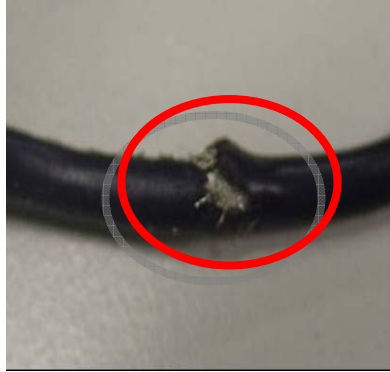
压线之后导致的线缆破雷
