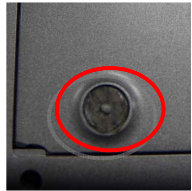
平推导致的脚垫脱落
