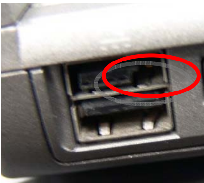
倾斜插入 USB 接口导致的损坏
