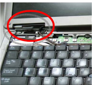
拎屏幕顶盖导致的转轴损坏
