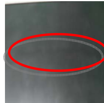
重物压过后在屏幕上形成的压痕
